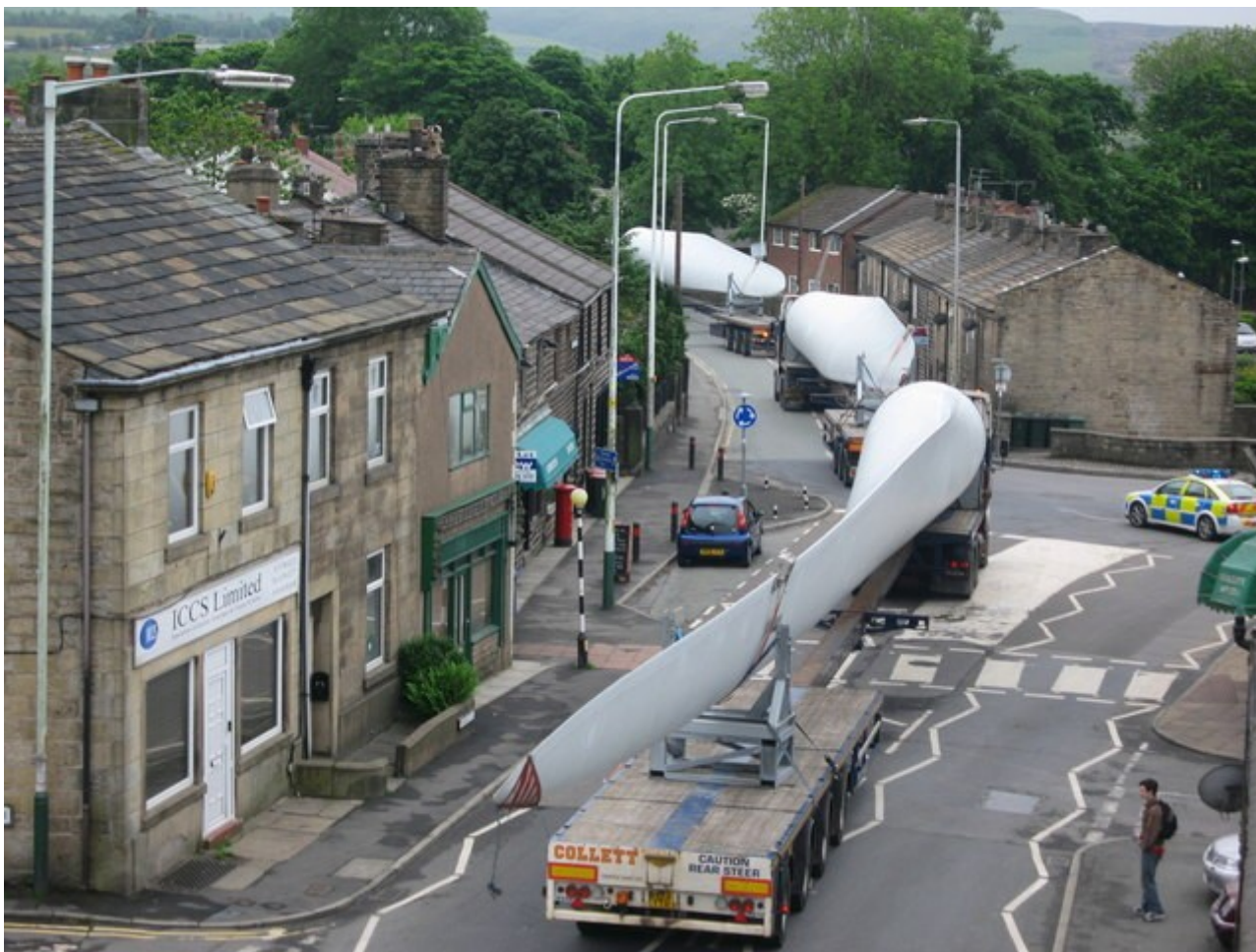
風力発電機のブレードを設置場所まで運んでいる様子(イギリス)
